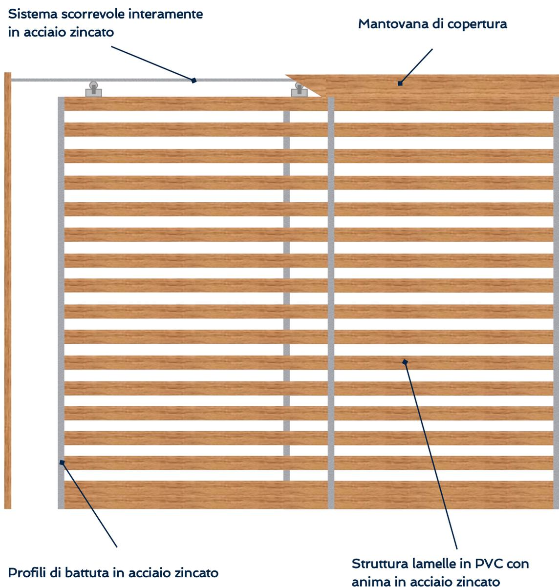
Il nuovo System EF SHADE permette di unire stile e praticità in un sistema per frangisole in PVC con anime in acciaio zincato con ante a scorrimento. Come ogni nostro prodotto è realizzato su misura nei nostri stabilimenti italiani, per offrirti un oggetto dal design ricercato e dalla tecnicità studiata per durare nel tempo.
